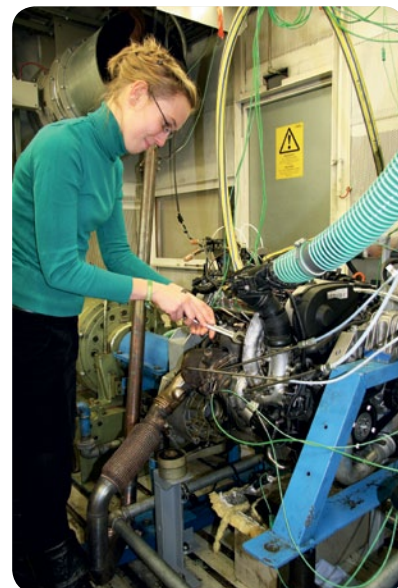
Maschinenbaustudentin Franziska Waldow untersucht während ihres Betriebstoffpraktikums einen PKW-Dieselmotor. Quelle: BildIng
