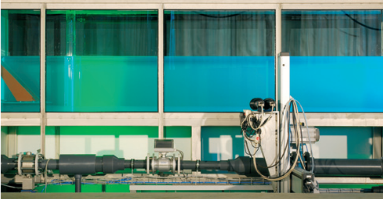
Kanal für geschichtete Strömungen am Lehrstuhl Strömungsmechanik mit laseroptischer Messtechnik (Abb. 3)
