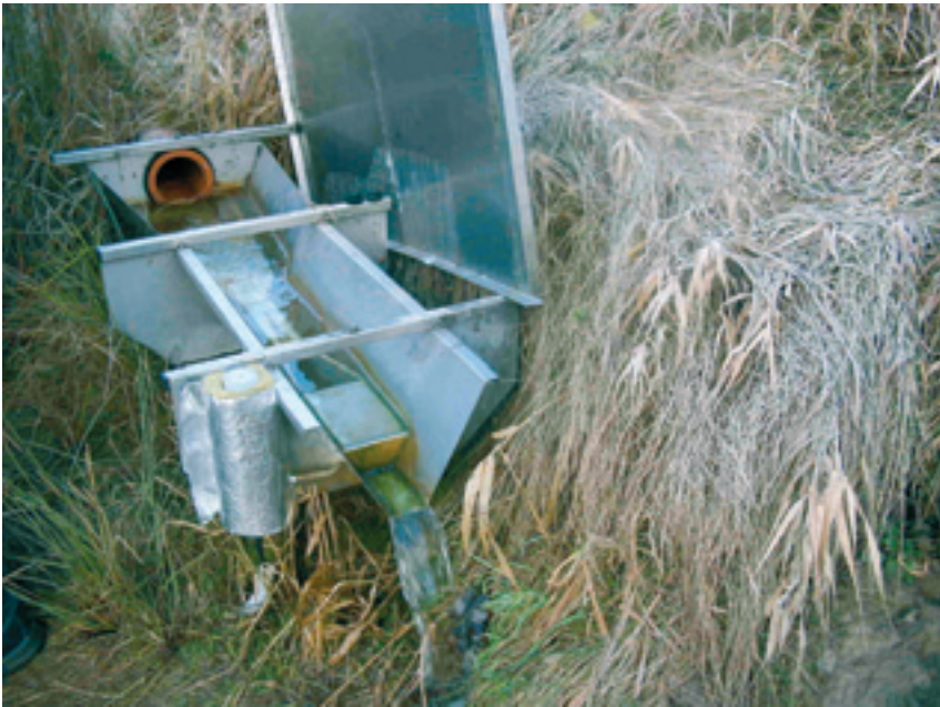
Durchflussmessung am Dränsammler (Abb. 3) Foto: Kahle
